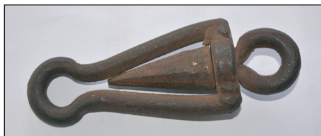
Draainagel op het verloop van de trekstrengen. Met dank aan Rik Pollet.
